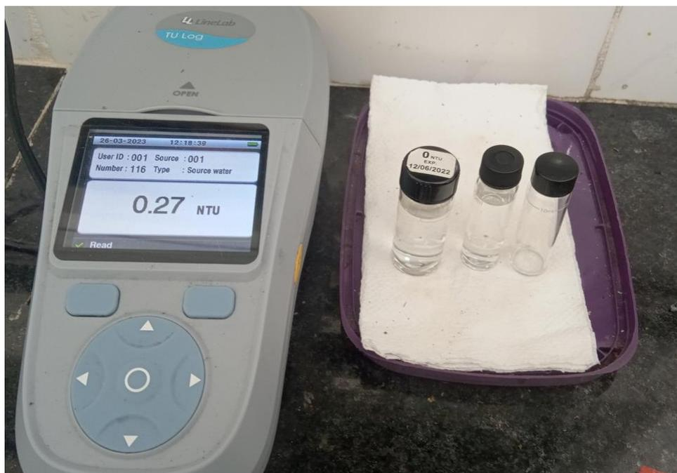
Figura 13: Turbidímetro digital de bancada Akso, modelo TU Log AS (Fonte: Autor, 2023).
