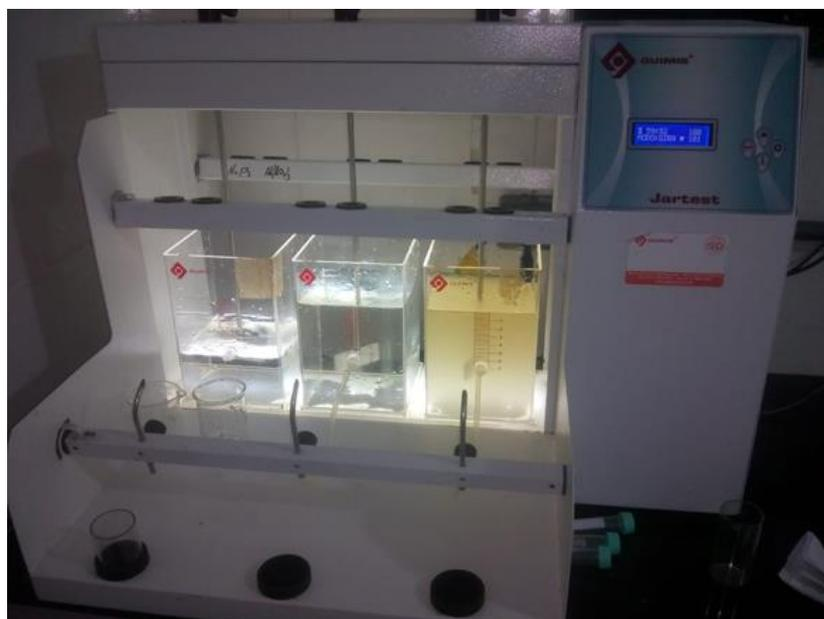
Imagem 7: Equipamento Jar Test utilizado para calibração das dosagens de produtos químicos (Fonte: Empreendedor, 2023).
