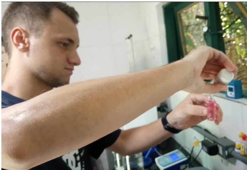
Imagem 27: Operador realizando aferição de cloro livre através do Método DPD (Fonte: Autor, 2023).
