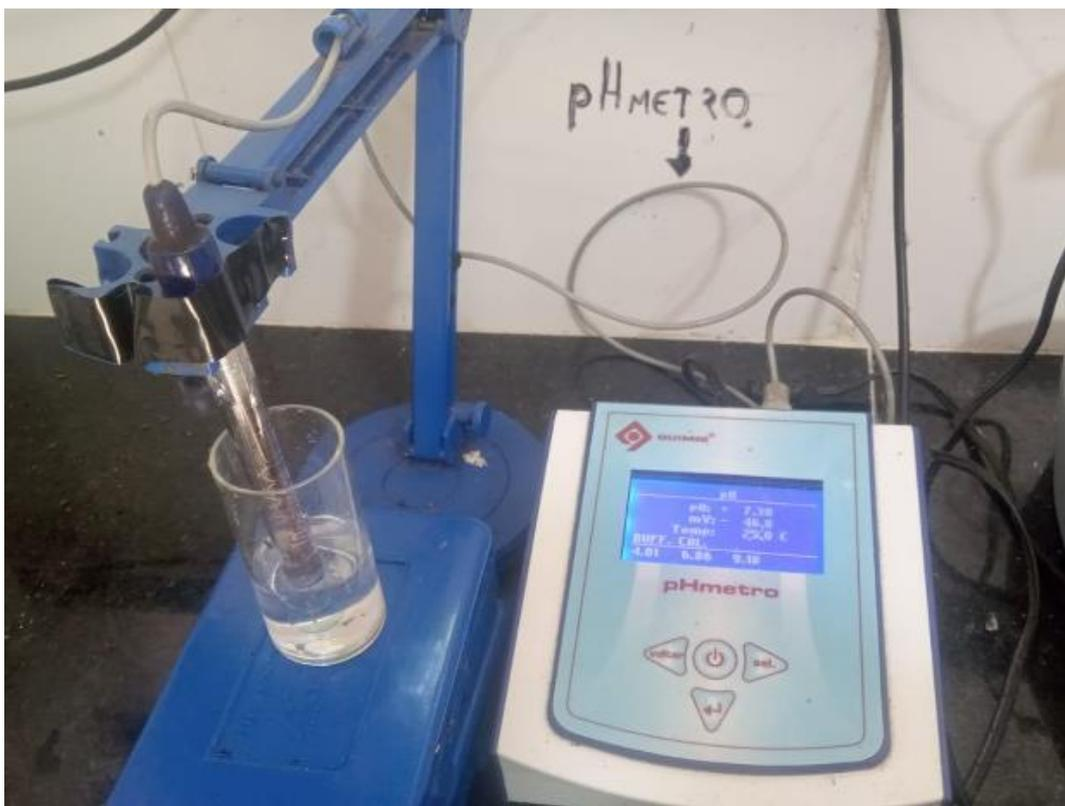
Figura 12: phmetro de bancada Quimis, modelo Q0400 AS, utilizado para aferição de faixa pH das amostras (Fonte: autor, 2023).
