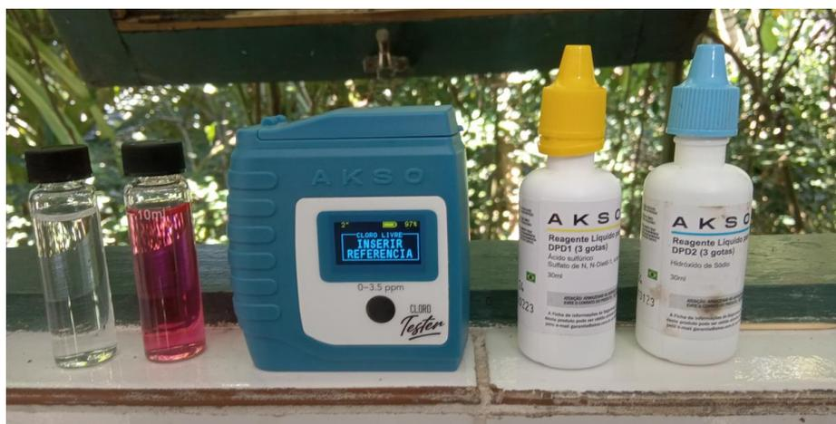
Figura 14: Clorímetro de bancada Akso, modelo Tester, utilizado para aferição de cloro livre (Fonte: Autor, 2022).
