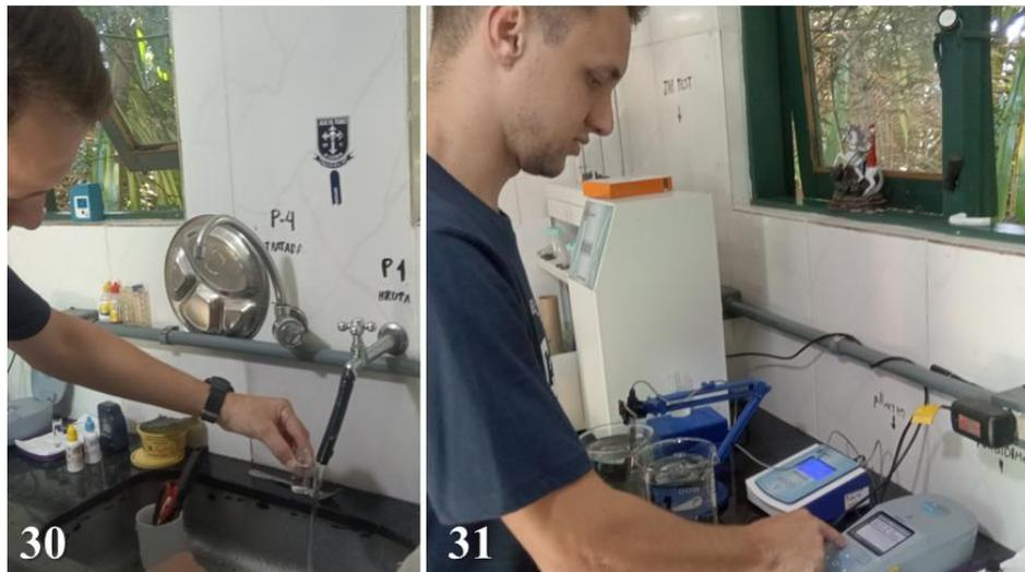
Figura 32 e 33: Operador realizando o procedimento de aferição de turbidez de uma amostra rotineira (Fonte: autor, 2023).
