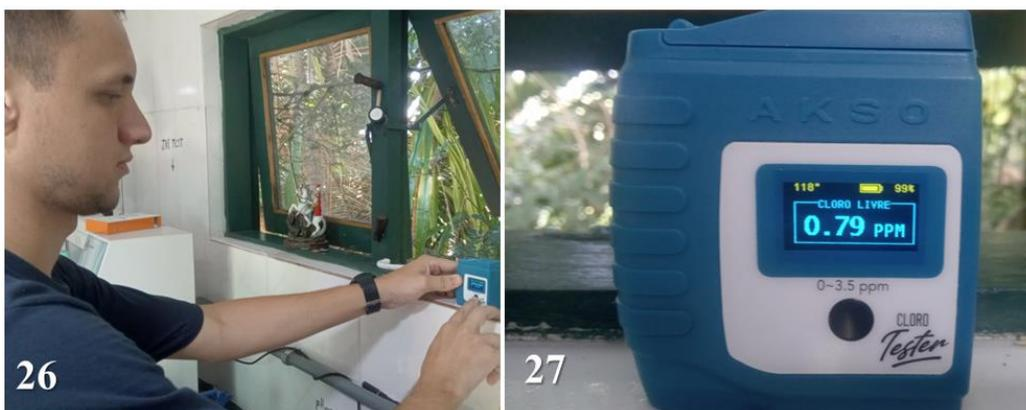
Figuras 28 e 29: Operador realizando aferição de cloro livre através do Método DPD (Fonte: Autor, 2023).
