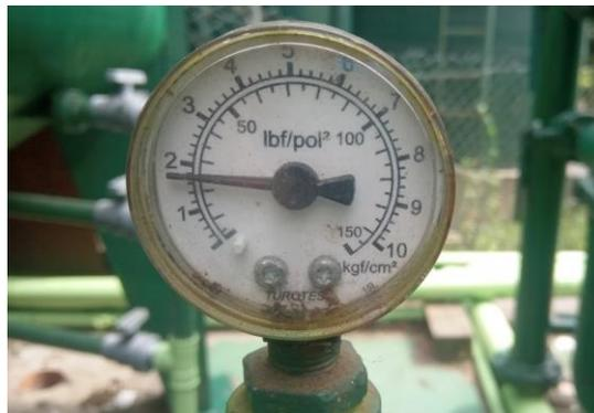
Figura 23: Medidor de vazão/pressão (Fonte: Autor, 2023).
