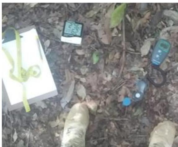
**Figura 5.** Fita métrica, termo-higrômetro digital, luxímetro e prancheta utilizados para a coleta de dados nos fragmentos florestais do município de Três Rios, Estado do Rio de Janeiro.
