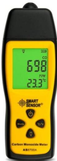
**Figura 11.** Carbon Monoxide Meter utilizado para medir o monóxido de carbono em Três Rios – RJ.
