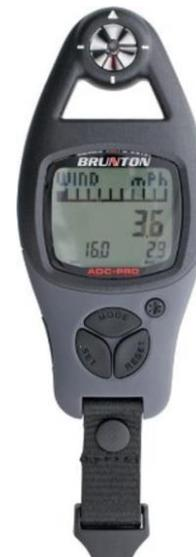
**Figura 14.** Brunton® / ADC PRO utilizado para medir a temperatura atmosférica em Três Rios – RJ.
