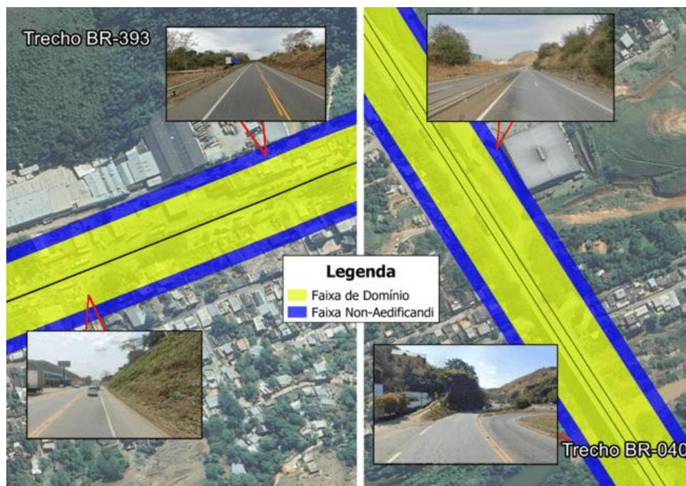
**Figura 28.** Registros fotográficos da BR-393 com possibilidade de deslizamento de massa, residências em áreas não edificante as margens da BR 040 e 393. Fonte: Google Earth Pro
