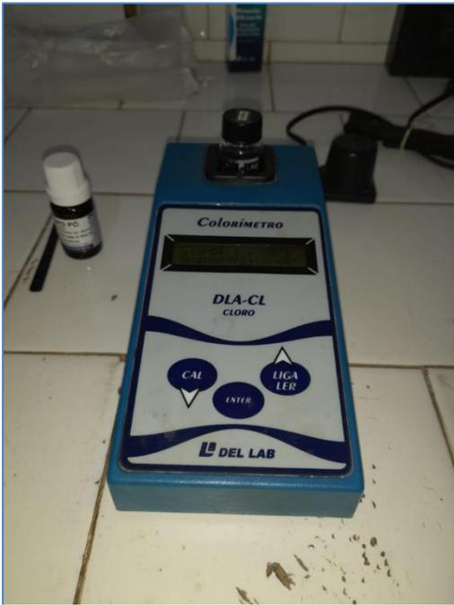
**Figura 15.** Colorímetro Microprocesado Digital.
