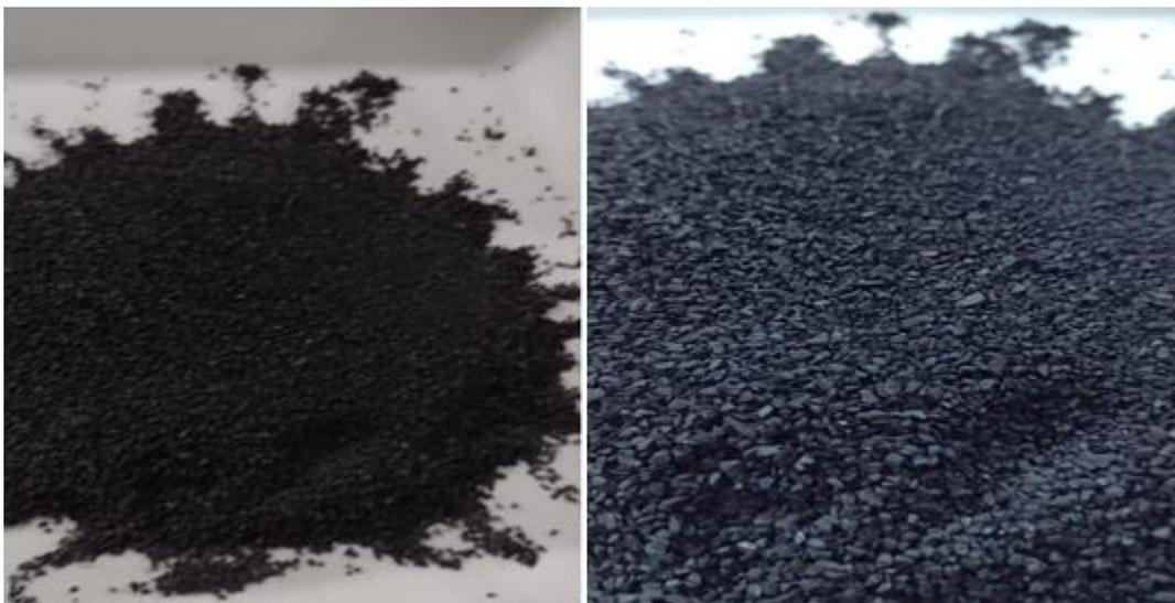
**Figura 24.** Meio filtrante catalítico Controll M.F. 574®.
