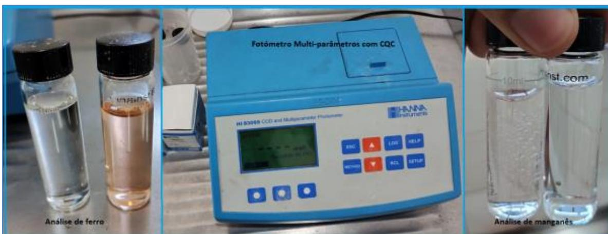
**Figura 18.** Fotômetro Multi-parâmetros com CQC.
