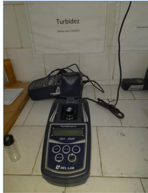
**Figura 16.** Turbidímetro Microprocesado Digital.
