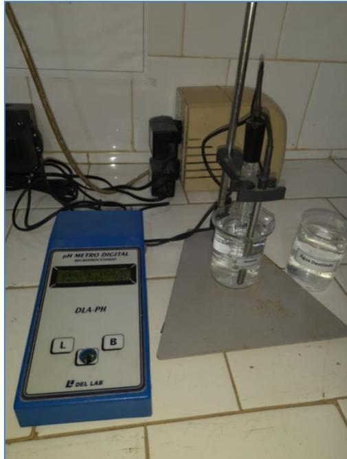
**Figura 17.** pHmetro Microprocesado. Digital.
