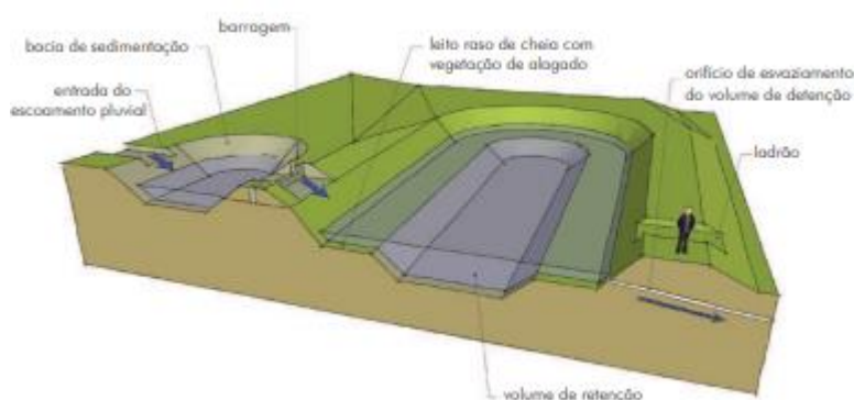
Figura 43. Esquema de uma Bacia de Detenção. Fonte: Nathaniel S. Cormier 2008.
