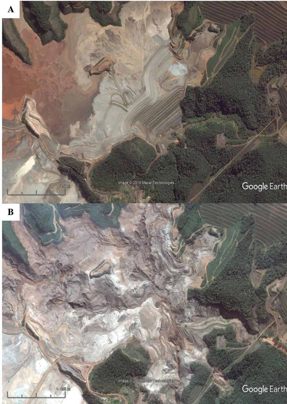
**Figura 3.** Barragem de Fundão antes do rompimento (A) (20/07/2015) e após o rompimento (B) (25/04/2016), no Município de Mariana, Estado de Minas Gerais. Fonte: Google Earth (2019).
