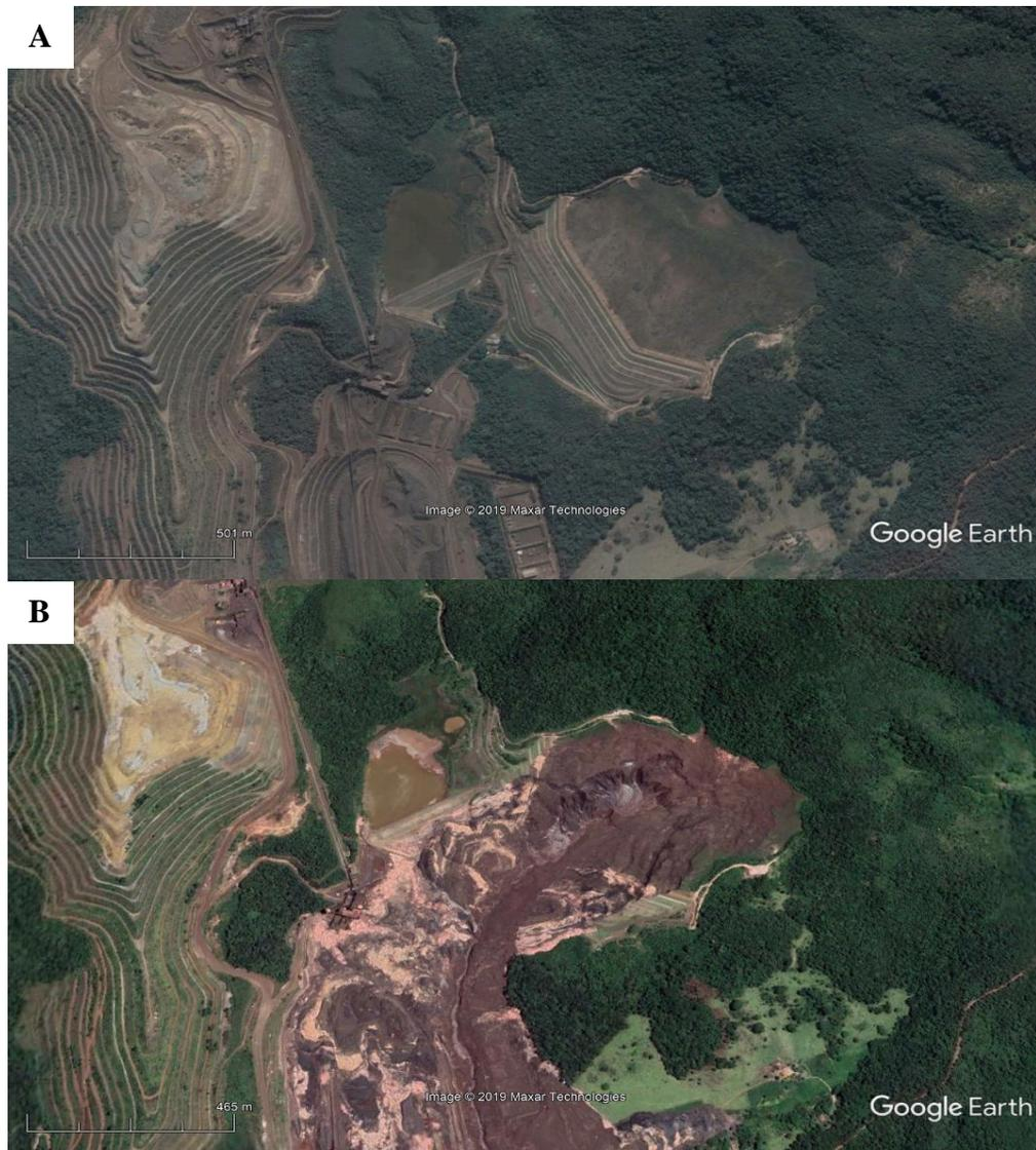
**Figura 5.** Barragem 1 antes do rompimento (A) (21/07/2018) e após o rompimento (B) (01/02/2019), no Município de Brumadinho, Estado de Minas Gerais. Fonte: Google Earth (2019).
