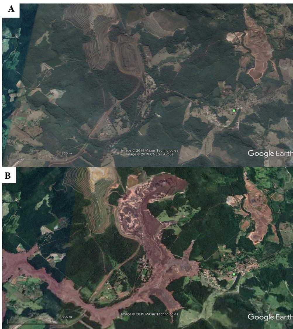
**Figura 6.** Barragem 1 antes do rompimento (A) (14/12/2018) e alterações ambientais observadas após o rompimento (B) (01/02/2019), no Município de Brumadinho, Estado de Minas Gerais. Fonte: Google Earth (2019).
