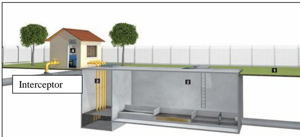
**Figura 3.** Ilustração de uma estação elevatória.
