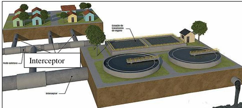
**Figura 2.** Ilustração de um interceptor.
