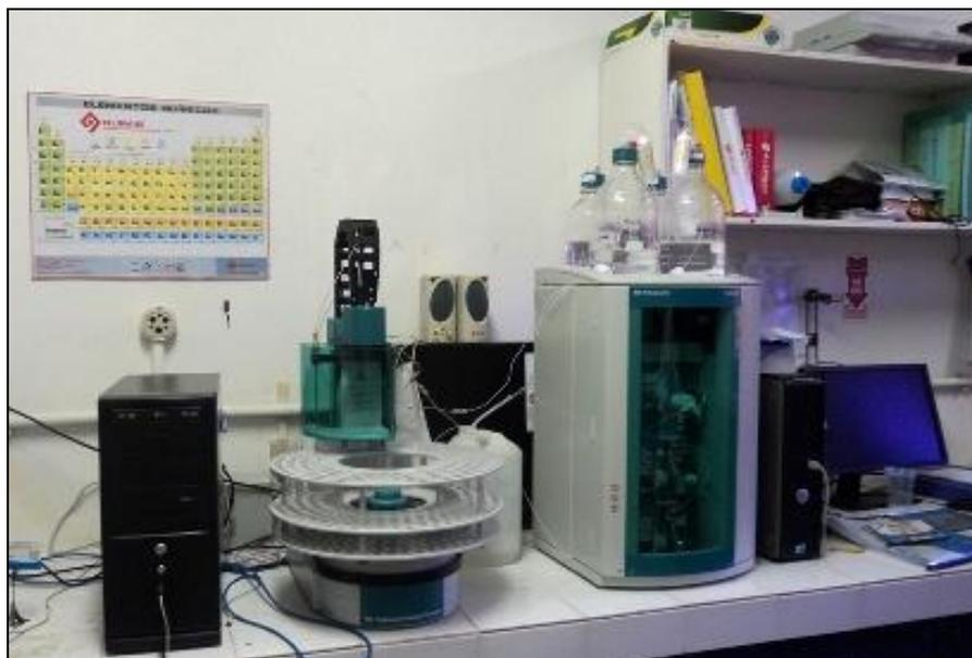
Figura 12: Íon cromatógrafo de troca iônica, equipamento Metrohm (Foto: Olga Gomes).
