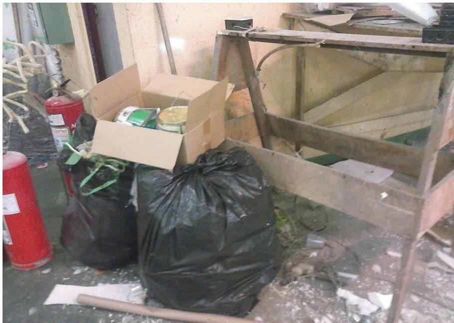
**Figura 3** - Latas de Adesivo à base de solvente sendo descartas juntamente com outros resíduos. Destaque para os extintores em posicionamento inadequado.
