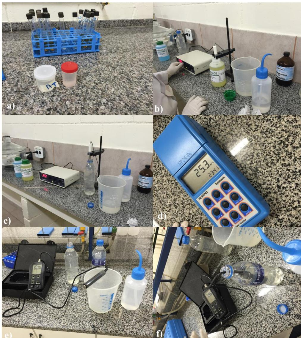
**Anexo 2.** Análise laboratorial da água da nascente do Sítio Santa Cruz III Gleba I. Onde: a) Reagente para análise, b) Análise do PH da água da nascente, c) Análise do PH da água da nascente d) Análise da turbidez da água da nascente, e) Análise da condutibilidade da água da nascente e f) Análise da condutibilidade da água da torneira da casa da propriedade.
