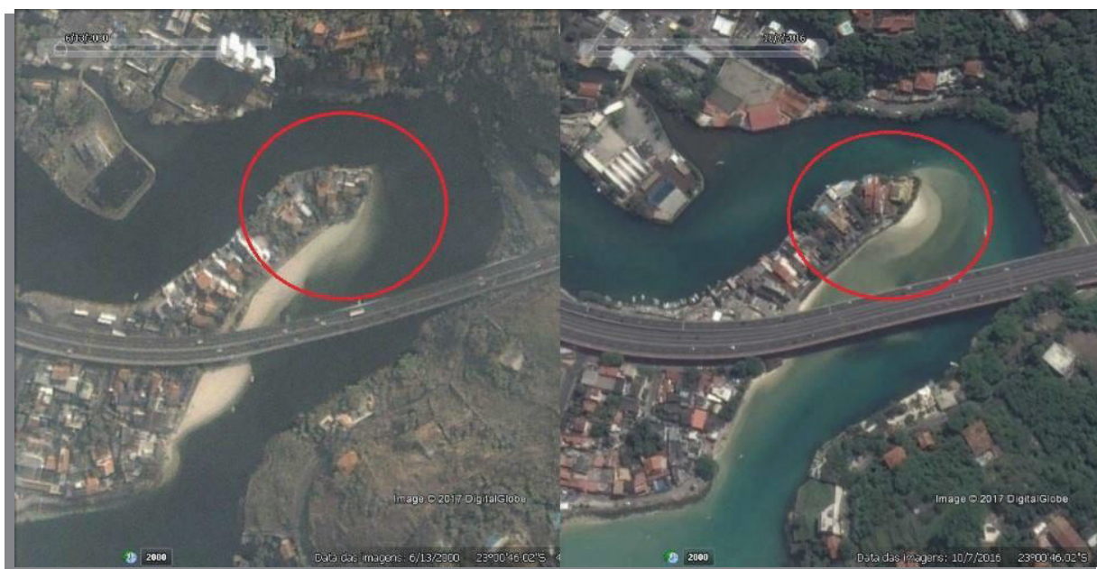
Figura 14. Assoreamento no Canal da Joatinga, em destaque, no ano de 2000, à esquerda e, à direita o canal no ano de 2016. – Fonte: Google Earth
