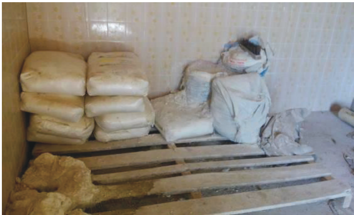
Figura 11. Os materiais utilizados para dosagem química, já obsoletos, eram adicionados à água Sulfato de Alumínio e Sulfato de Cálcio. Novembro, 2015.
