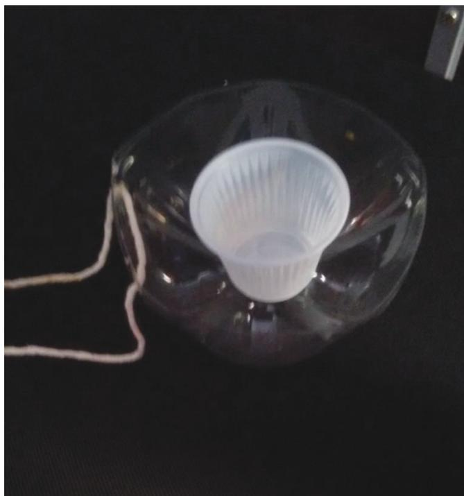
**Figura 2.** Armadilha arbórea para formigas baseada na proposta de Oliveira-Santos et al. (2009).
